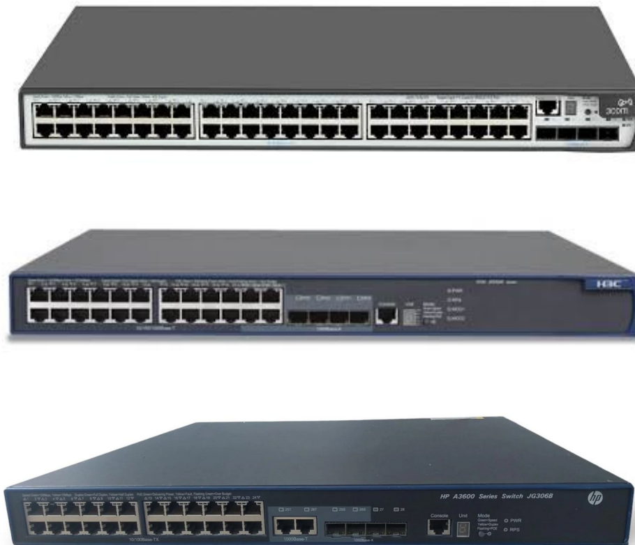
Figs. B1, B2 et B3 (ordre respectif descendant) : Modèles de commutateurs 3COM 5500-EI, H3C S5500 et HP A3600 (respectivement) présents en versions 24 et 48 ports, constituant la grande majorité du matériel à diagnostiquer et réinitialiser
