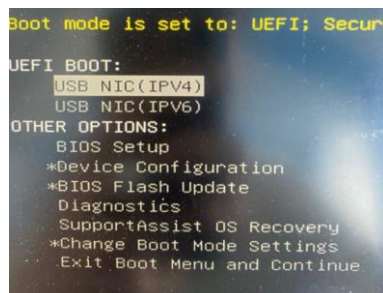
Figure 28 : Boot sur le réseau
