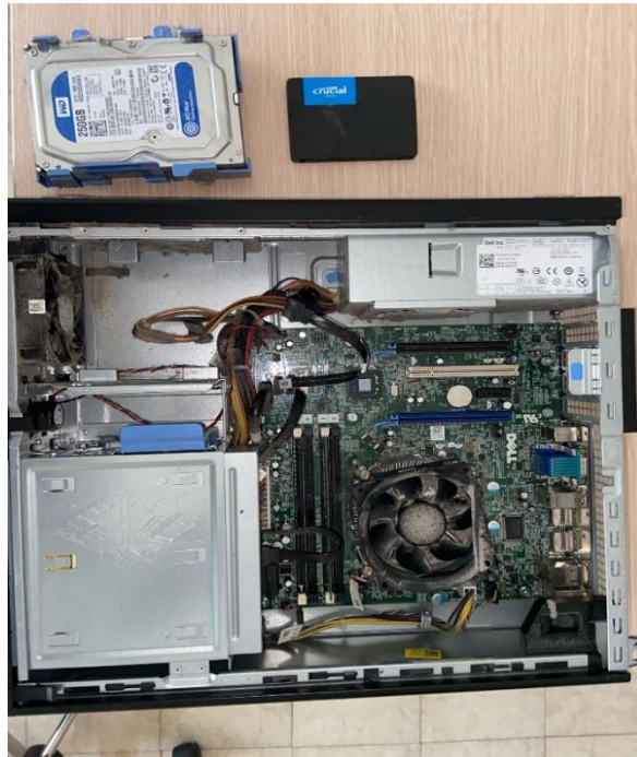
Changement de disque dur vers disque SSD
