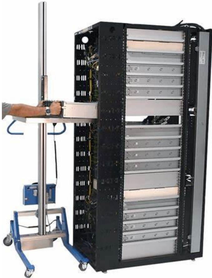
Figure 7 Procéder à l'extraction d'un serveur
