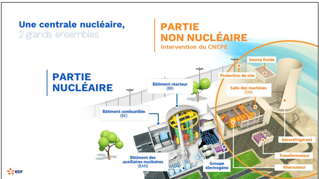
Figure 1 – Les principales composantes d'une centrale nucléaire
