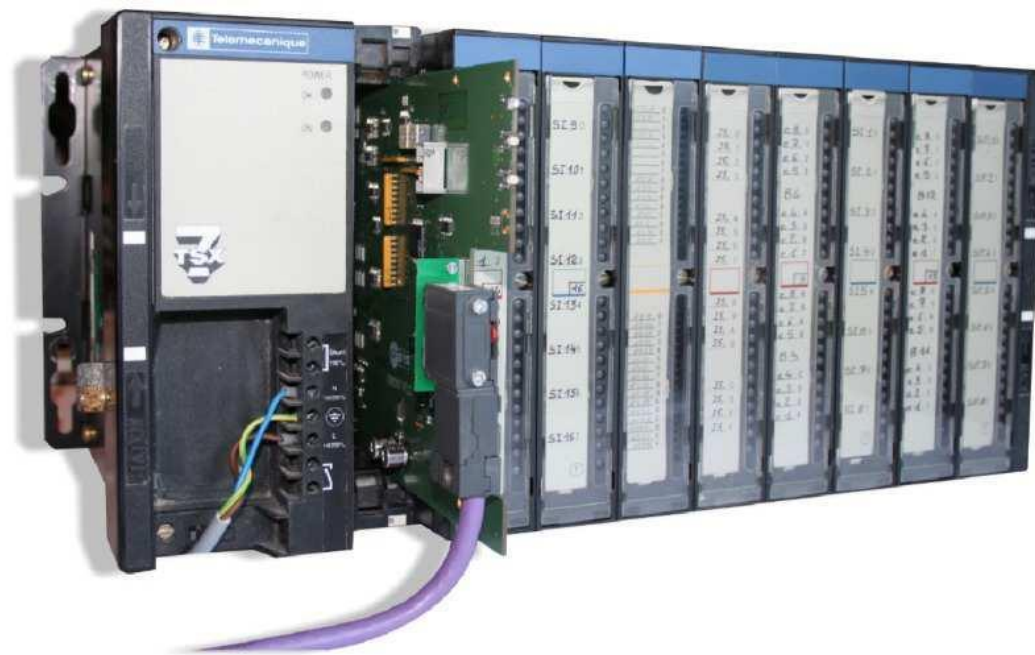
Figure 11 : Un automate Schneider TSX 7
