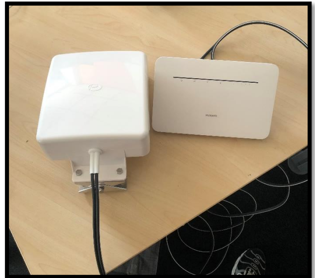
Figure 65 : antenne et son routeur 4G
